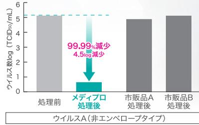
【試験方法】 ウイルスをメディプロトイレクリーナー又は市販のトイレ用洗剤に接種、5分後の残存ウイルス数を測定。(試験はモデル系で実施/当社調べ)
